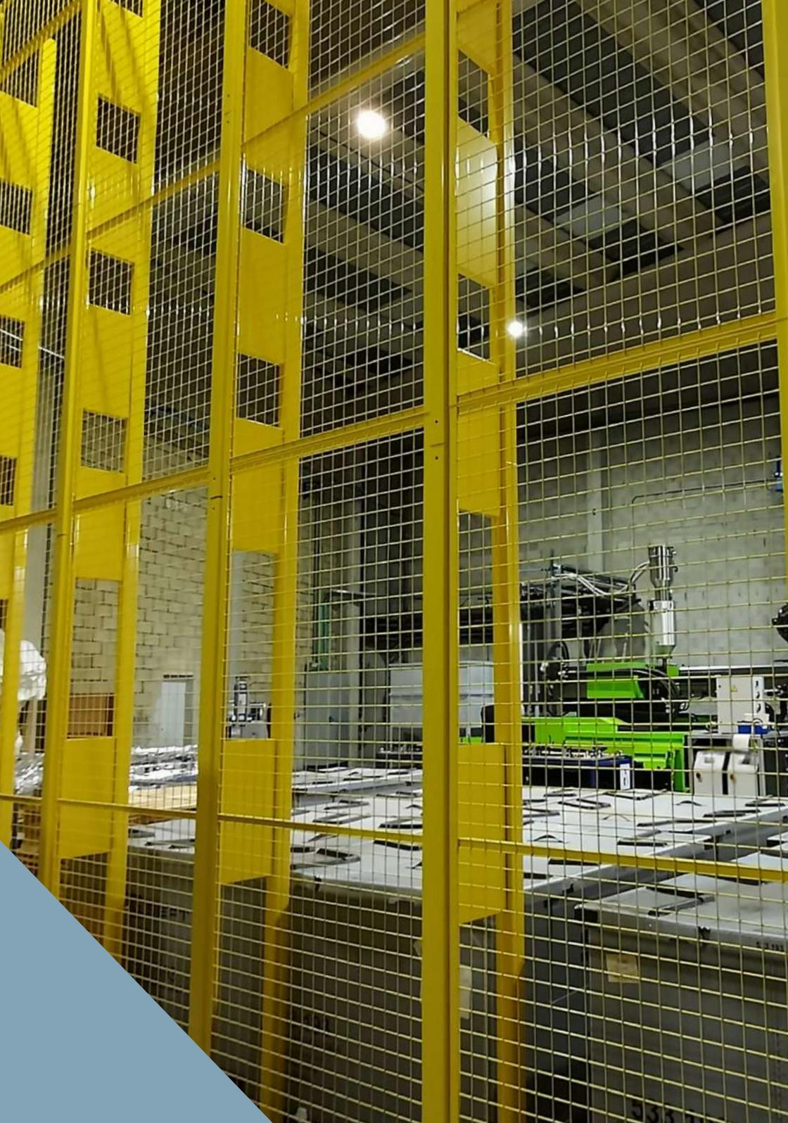
bis zu 10 500 mm bei einem Bodenabstand von 180 mm erreichen und sorgen so für die nötige Stabilität und Sicherheit.
